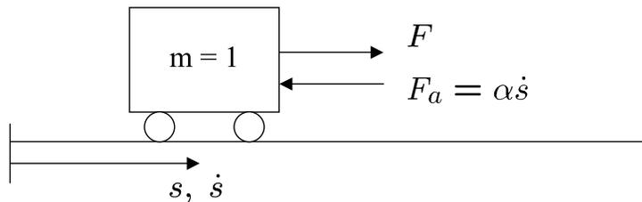
1.1 Posto  $x_1 = s$  e  $x_2 = \dot{s}$ , si scrivano le equazioni nelle variabili di stato  $x_1$  e  $x_2$  del sistema carrello con ingresso  $u$  dato dalla forza  $F$  e uscita  $y$  data dalla sua posizione  $s$  lungo la guida rettilinea.
