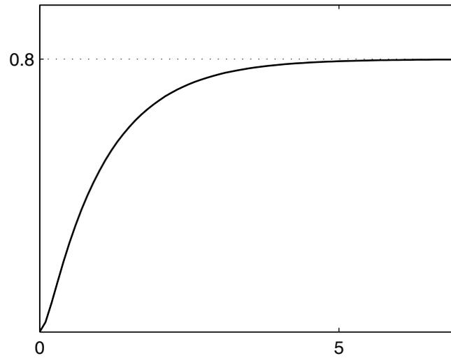
2.5 Tracciare l'andamento della risposta forzata del sistema con funzione di trasferimento  $H(s) = \frac{8}{s^2+11s+10}$  all'ingresso  $u(t) = sca(t) - sca(t - 10)$ .
