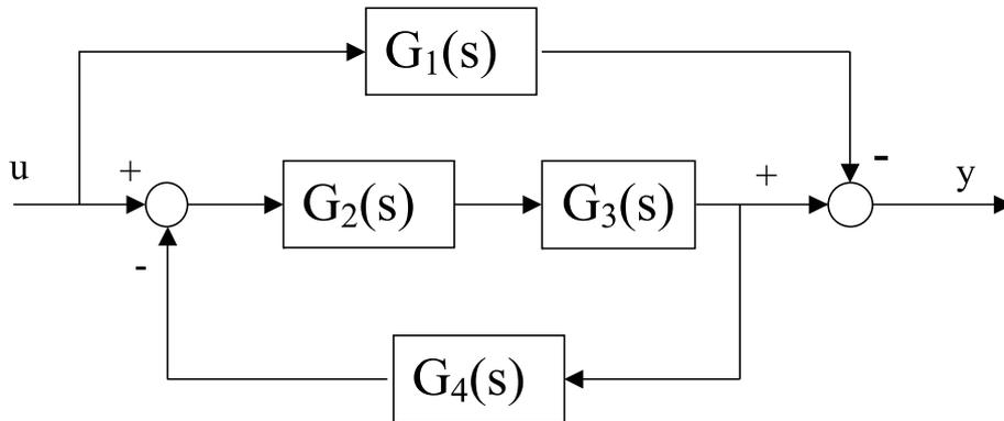
2.1 Scrivere l'espressione della funzione di trasferimento  $H(s)$  del sistema con ingresso  $u$  ed uscita  $y$  in termini di  $G_1(s)$ ,  $G_2(s)$ ,  $G_3(s)$  e  $G_4(s)$ .
