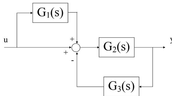
3.1 Scrivere l'espressione della funzione di trasferimento  $H(s)$  del sistema con ingresso  $u$  ed uscita  $y$  in termini di  $G_1(s)$ ,  $G_2(s)$ , e  $G_3(s)$ .
