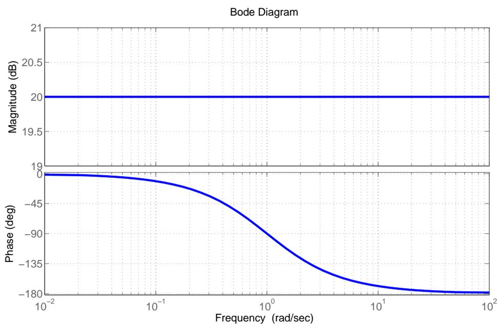
2.1 Dire, motivando la risposta, quanto valgono tipo, guadagno, poli e zeri della funzione di trasferimento  $G(s)$  del sistema. Scrivere l'espressione di  $G(s)$ . É possibile valutare le proprietà di stabilità del sistema da  $G(s)$ ?
