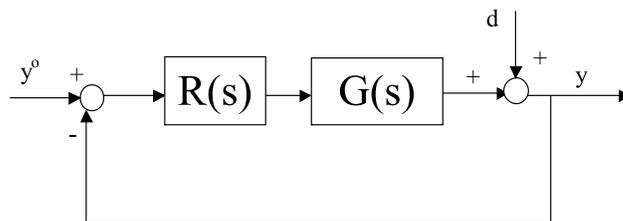
Determinare la funzione di trasferimento  $R(s)$  di un regolatore PI in modo da soddisfare le seguenti specifiche:
