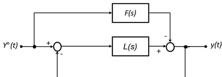
2.1 [2 punti] Determinare l'espressione della funzione di trasferimento  $H(s)$  del sistema con ingresso  $y^\circ$  e uscita  $y$  in funzione di  $F(s)$  e  $L(s)$ .
