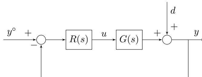
5.1 Determinare i valori dei parametri  $k$  e  $T_I$  della funzione di trasferimento  $R(s)$  di un regolatore PI  $R(s) = k\left(1 + \frac{1}{sT_I}\right)$  in modo tale che siano soddisfatte le seguenti specifiche:
