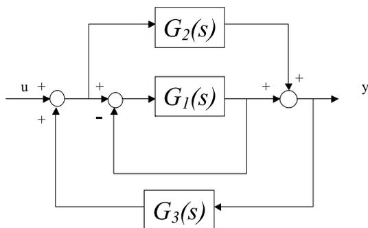
Determinare l'espressione della funzione di trasferimento  $G(s)$  del sistema con ingresso  $u$  ed uscita  $y$  in funzione di  $G_1(s)$ ,  $G_2(s)$  e  $G_3(s)$ .
