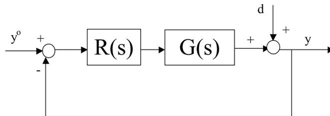
4.1 [5.5 punti] Determinare la funzione di trasferimento  $R(s)$  del regolatore in modo da soddisfare le seguenti specifiche:
