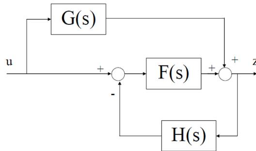
2.1 [1.5 punti] Scrivere l'espressione della funzione di trasferimento  $W(s)$  del sistema con ingresso  $u$  e uscita  $z$  in termini di  $G(s)$ ,  $F(s)$ , e  $H(s)$ .
