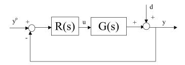
Determinare la funzione di trasferimento  $R(s)=k\left(1+\frac{1}{sT_I}\right)$  di un regolatore PI in modo che:
