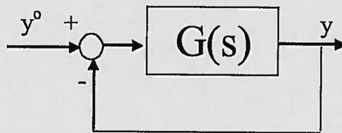
a) Verificare che il sistema retroazionato è asintoticamente stabile e tracciare la risposta del sistema all'ingresso  $y^o(t) = sca(t)$ .
