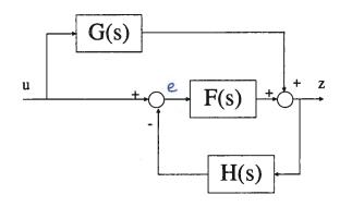
Scrivere l'espressione della funzione di trasferimento V(s) del sistema con ingresso u ed uscita z in termini di G(s), F(s), e H(s).
